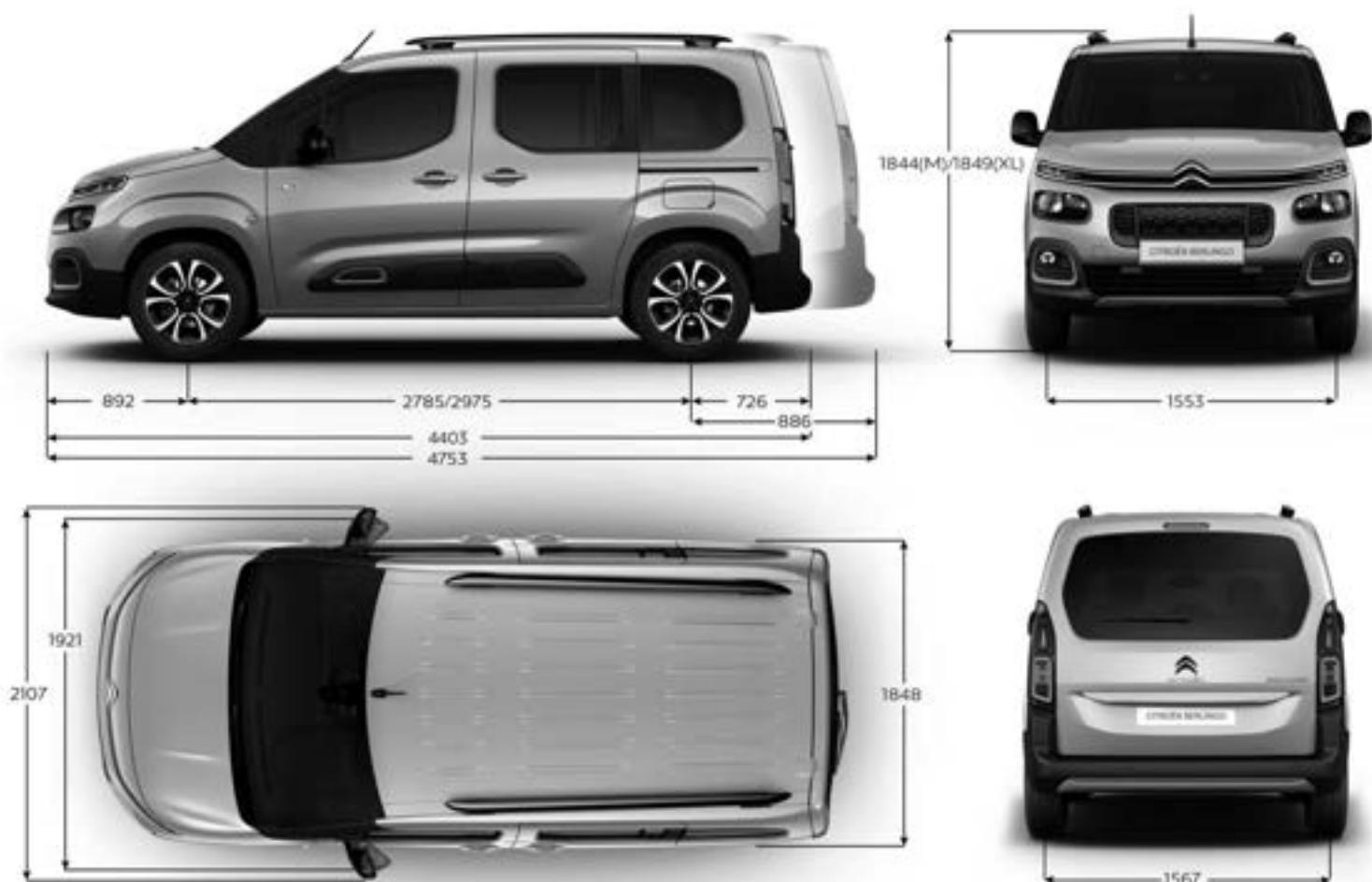
Kofferraumvolumen (Konfiguration mit 5 Plätzen): 775 Liter bei Länge M / 1.050 Liter bei Länge XL
